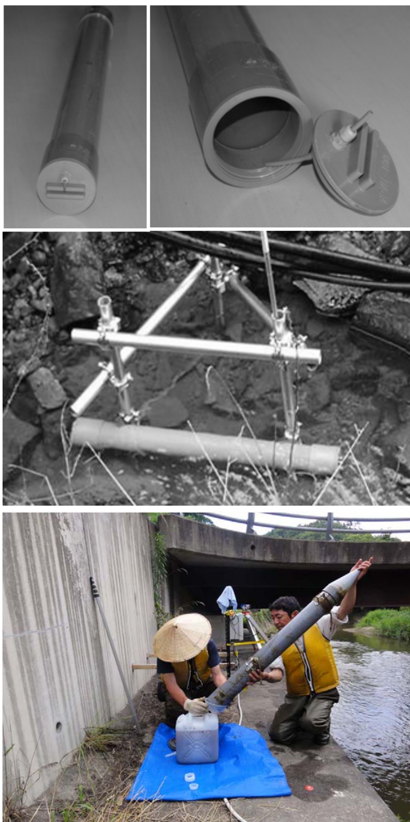
図 4. 2. 4-1 浮遊砂サンプラーの採取口の構造（上）、河床に設置した浮遊砂サンプラー（中）、 浮遊砂の回収状況（下）
