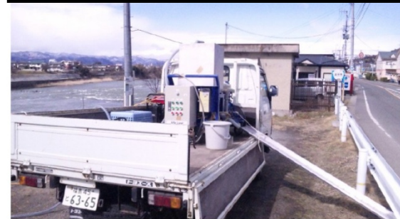
写真 5.3.3-1 連続遠心装置(MAB 103B-24, Alfa Laval)
