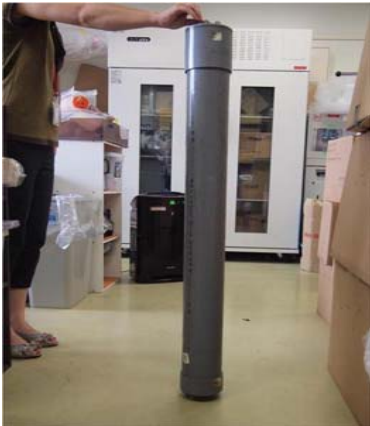
図 浮遊砂サンプラー(右図は側溝への設置例)
