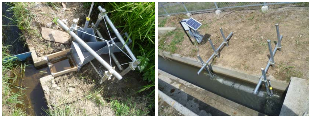
写真-1 水田流入口における観測機器 (左：パーシャルフリューム／右：浮遊砂サンプラー)
