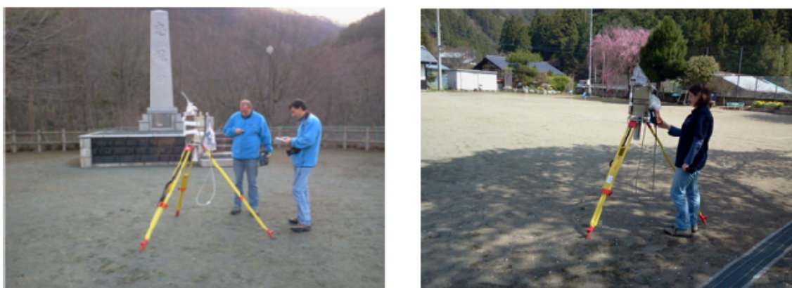
図1 可搬型Ge検出器を使用したin situ測定の様子
