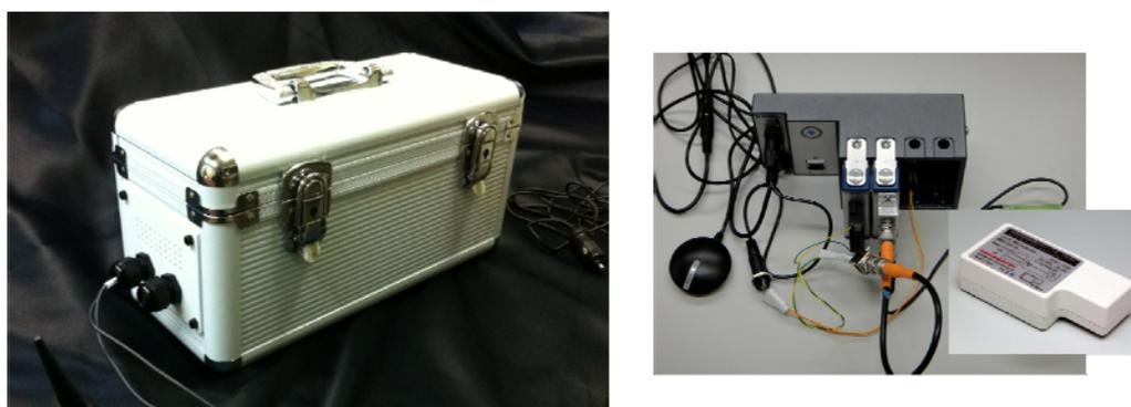
図2 KURAMA2システムの外観（左）とモジュール（右）
