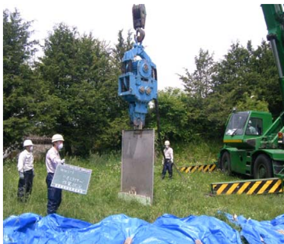
(a) ワイドジオスライサー (幅1.1m×深さ1.2m×厚さ10cm) による土壌採取の状況
