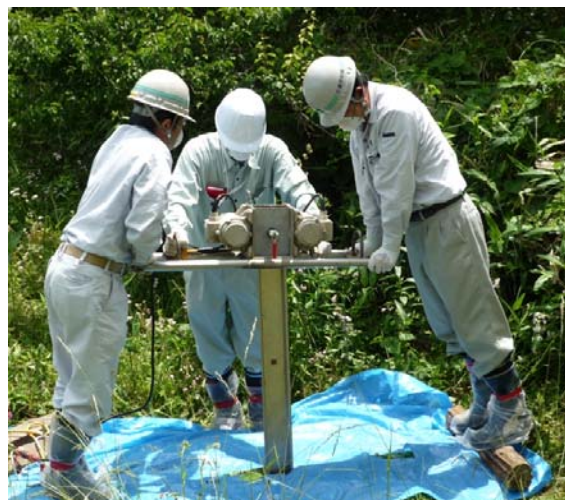
(b) ハンディジオスライサー (幅10 cm×深さ1.0m×厚さ2cm ) による土壌採取の状況
