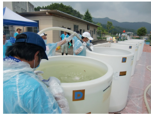
PAC注入後のpHを測定
