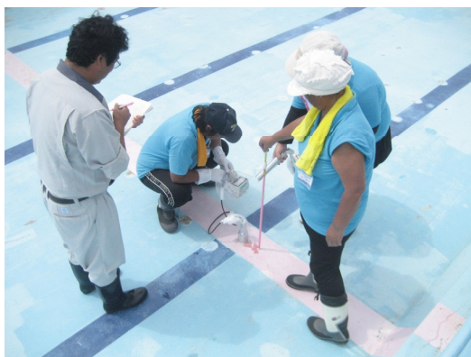
仮洗浄後のプール底表面の汚染検査
