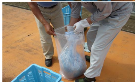
汚泥をシーツごとビニール袋に移動し、これをさ らにビニール袋に入れて二重に包む
