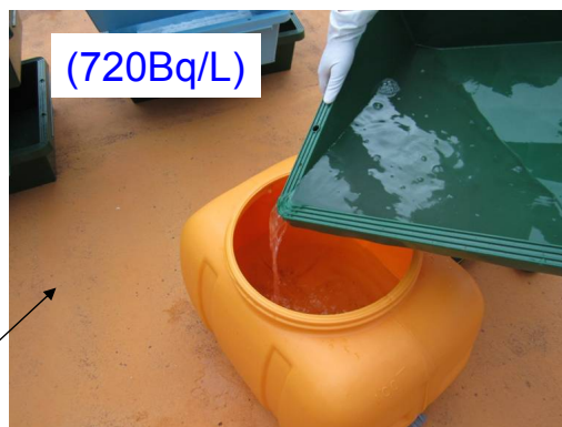
②最終的に残ったろ過液を全て 100Lタンクに移動し、線量を確認
