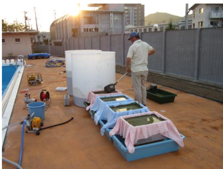
タンクの汚泥を柄杓で濾過器具に移動
