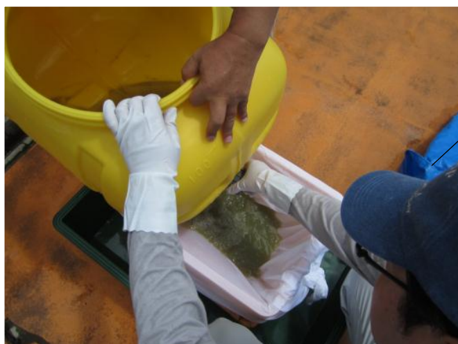
①初流はゼオライト処理して再ろ過 (この状態では汚染物を濾過できず)
