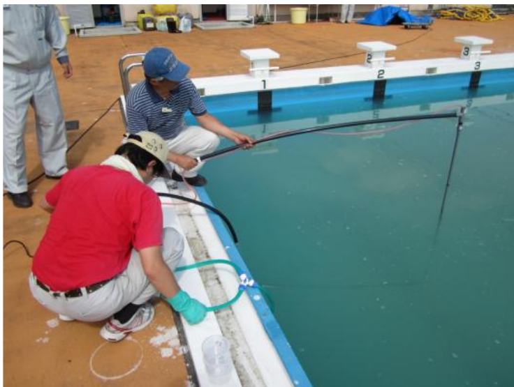
小型ポンプでプール各深さ (10, 50, 90cm)の 処理水を採水 (写真は場所D)
