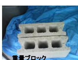
重量ブロック
