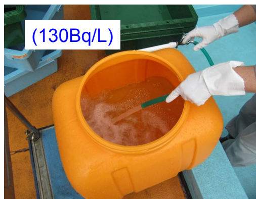
③目安となる放射能濃度を超えたため、水道45で 希釈し、目安以下であることを確認して排水
