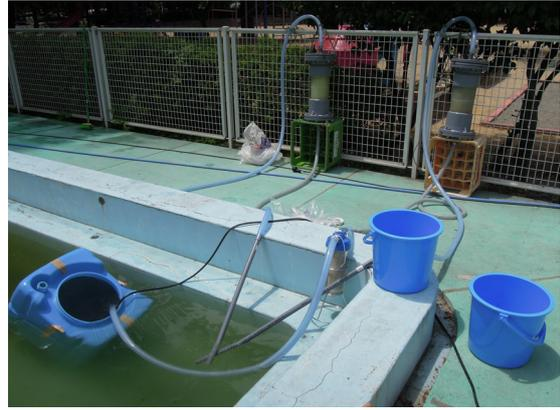
写真1 捕集材フィルタを利用した方法：(左) 作業の様子、(右) 設置状況
