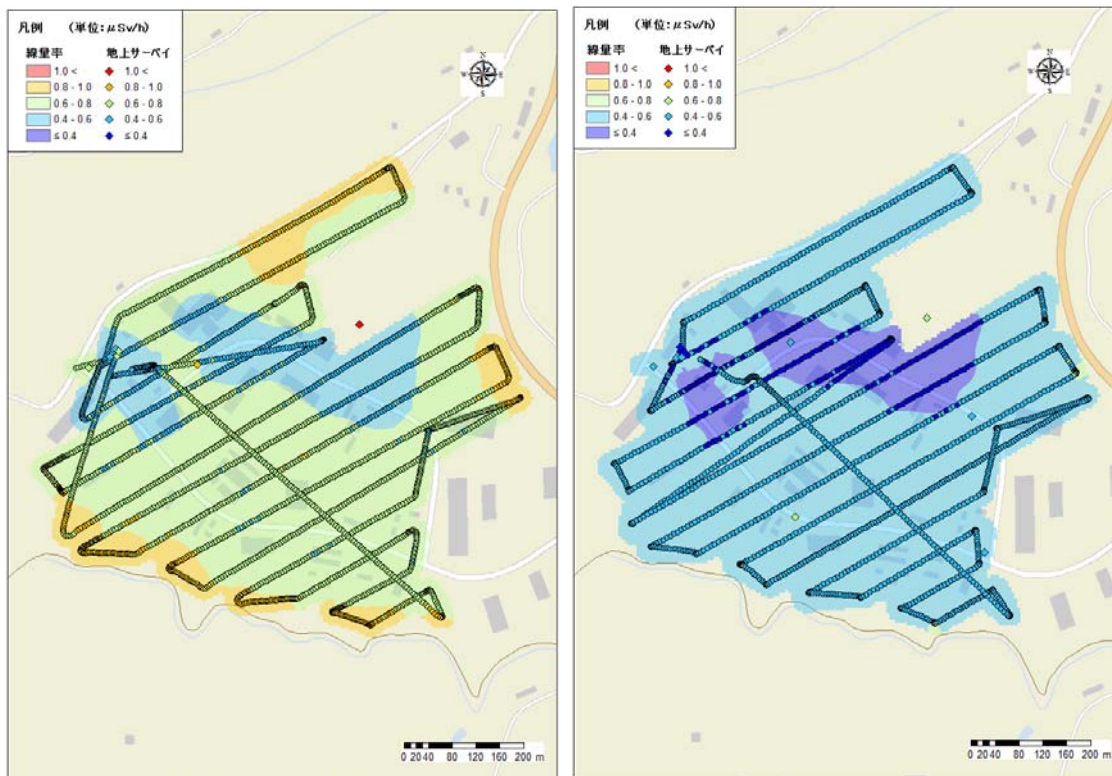
図 4.3-1(9) 無人ヘリによる除染前後のサーベイ結果 (左：除染前，右：除染後)
