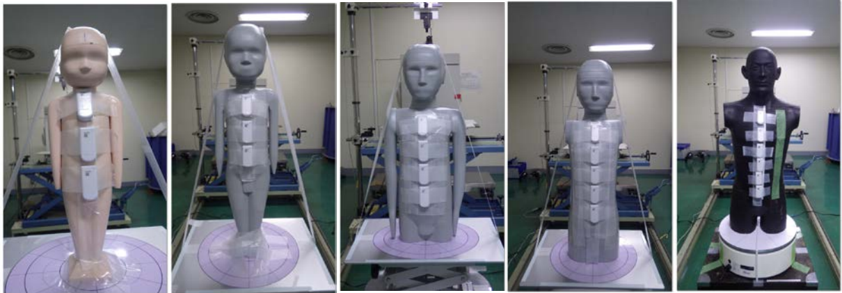
図 12 年齢別人体形状ファントムにおける個人線量計 C の設置状況 (左から、0 歳児、1 歳児、5 歳児、10 歳児及び成人を模擬したファントム)
