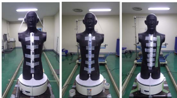
図5 人体形状ファントムにおける個人線量計の設置状況 (左：個人線量計 A1，中央：個人線量計 A2，右：個人線量計 C)
