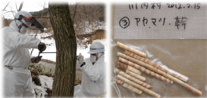
伐採せず、φ5.5mm、長さ約20cmの生長錐で幹の試料を採取。
