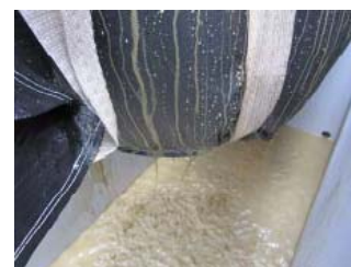
脱水用フレキシブルコンテナ 減容(脱水)状況
