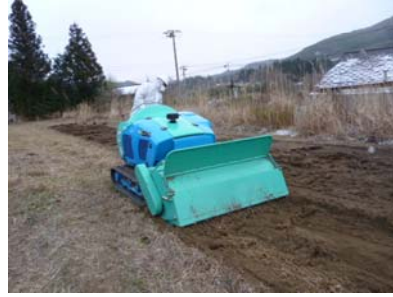
薄層表土剥ぎ取り機による表土剥ぎ取り
