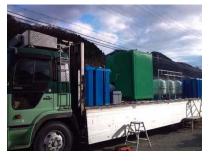
〈車載型水処理設備〉 ゼオライト等による吸着処理
