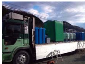
<ゼオライト等による水処理(車載型水処理設備)>
