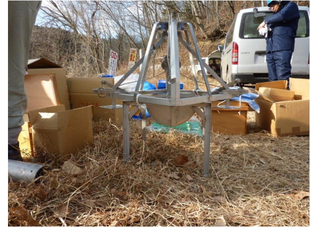
湖底堆積物試料の採取(スミス・マッキンタイヤ採泥器)
