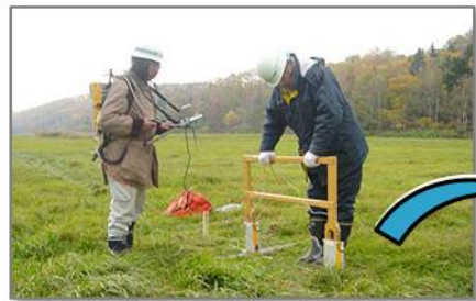
土壌分布の調査 (地中レーダー探査)
