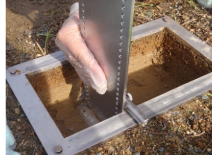
スクレイパープレートを用いた土壌試料の採取
