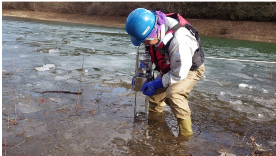
柱状堆積物試料の採取(不攪乱柱状採泥器)
