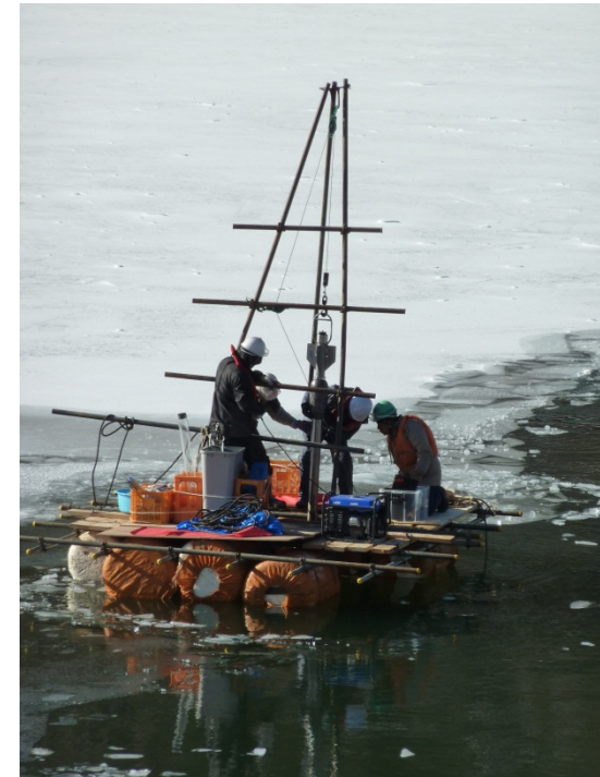
柱状堆積物試料の採取(重錘型柱状採泥器)
