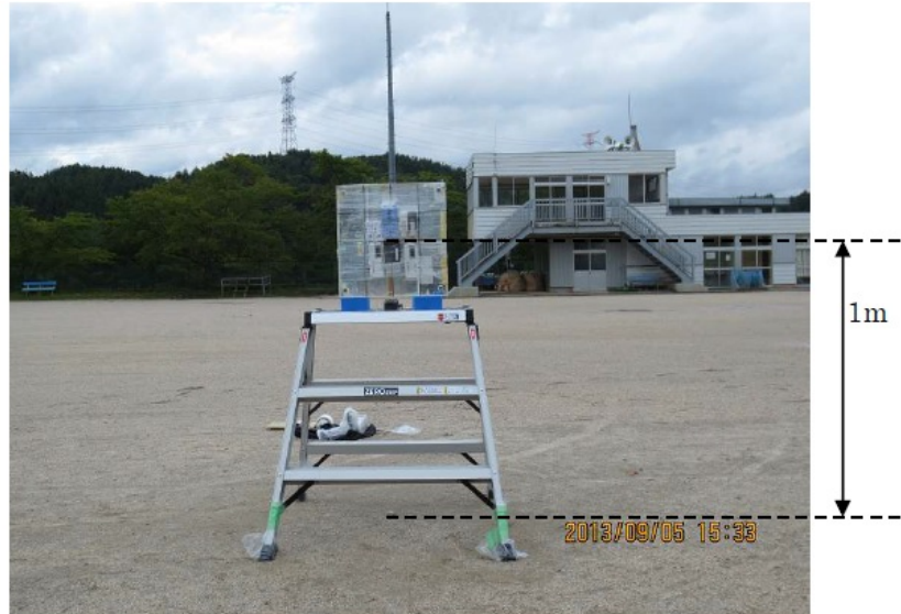
図2. ファントム（P-40）に取り付けた個人線量計
