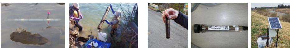
浮遊砂サンプラー 懸濁態試料採取 水位計 濁度計 ロガー
