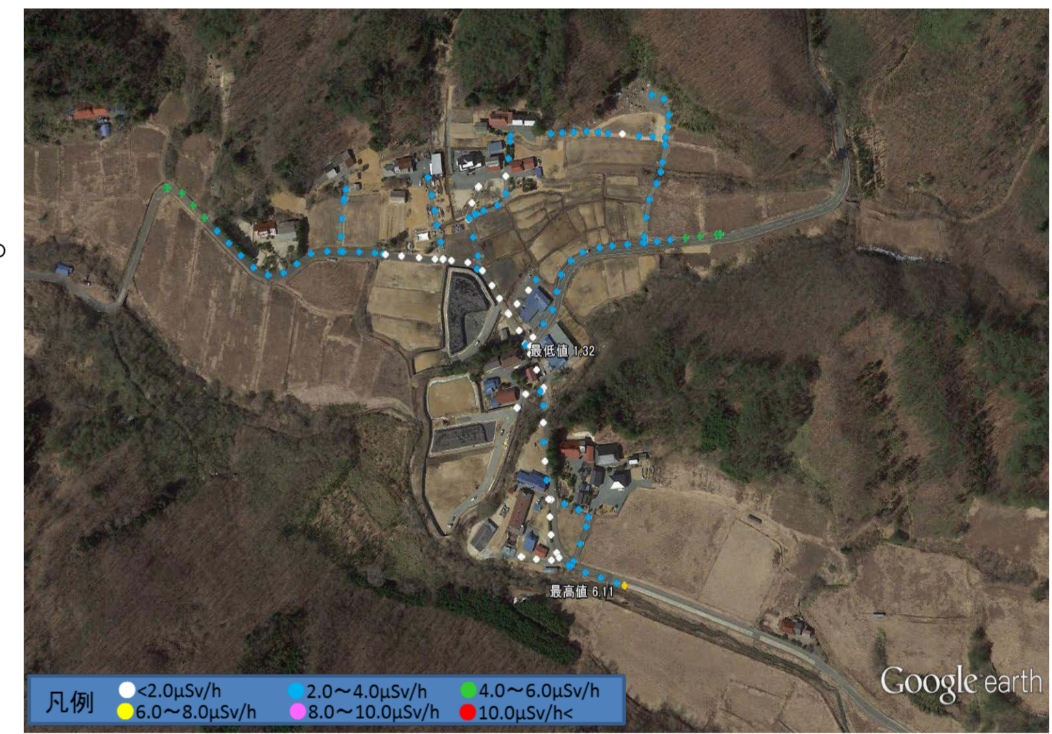
図5 ガンマプロッタHによる測定結果（赤宇木地区の例）
