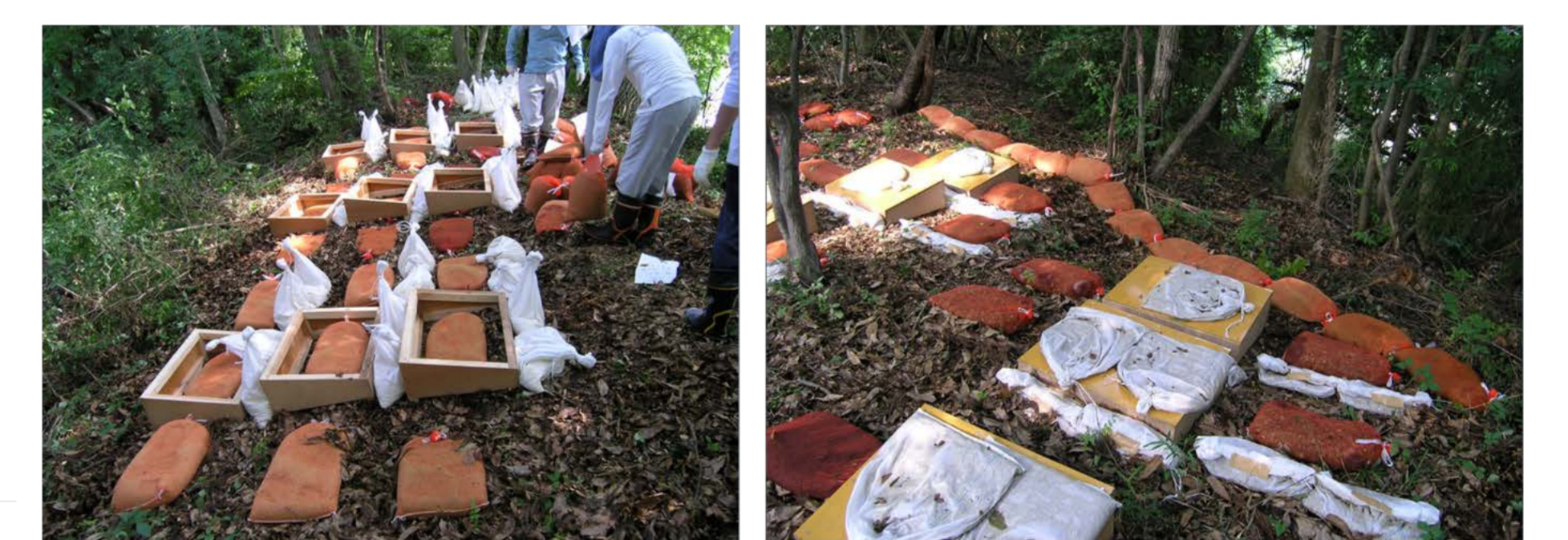
予備試験結果 菌床下土壌中濃度 18000Bq/m 2 廃菌床中濃度 4800 Bq/m 2 回収率 約 20% (植物による回収の数十から百倍)
