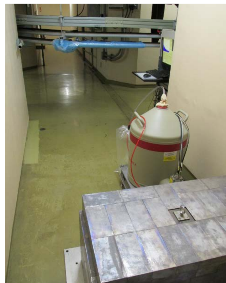
原子力機構タンDEM加速器施設地下2階通路に設置したGe検出器
