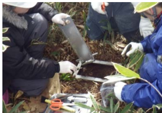
森林調査(スクレーパープレート による試料採取: 地表面から 深度20cmまで)
