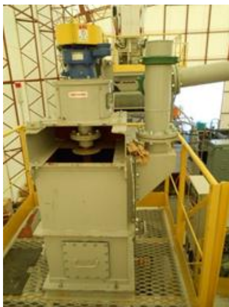
写真-3 表面処理後のスクラビング・フローテーション
