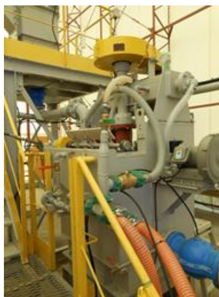
写真-3 表面処理後のスクラビング・フローテーション
