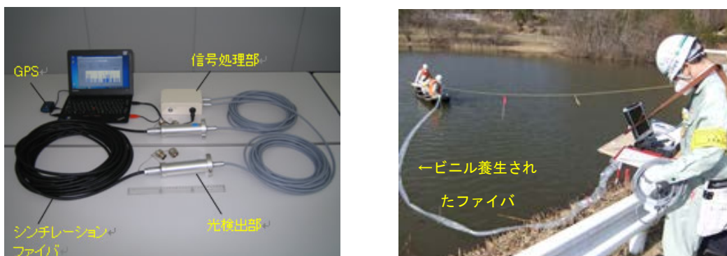
図 4.5-2 プラスチックシンチレーションファイバ （左図：測定機器、右図：ため池での測定状況（水中に沈める前）、大成建設株式会社）
