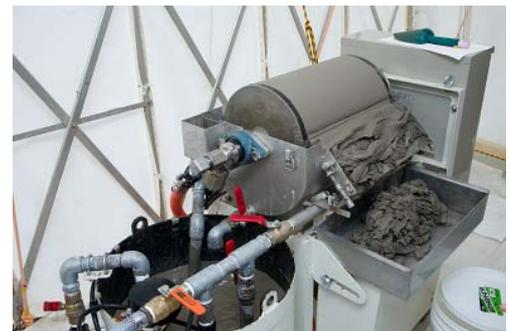
図 2.4 真空脱水機での飛灰回収状況
