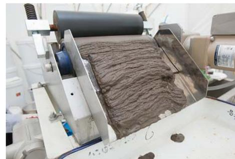
図 2.3 セパレータでの除染剤回収状況
