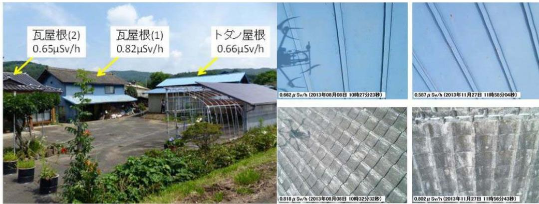
図 3.11 民家の屋根上の空間線量率計測および測定中の写真の撮影
