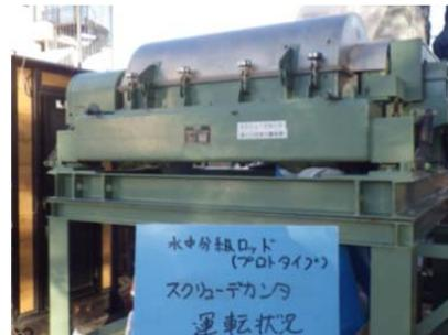
写真-11 脱水機処理機運転状況
