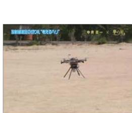
ミニサーベイヤーによる空間線量率自動計測
