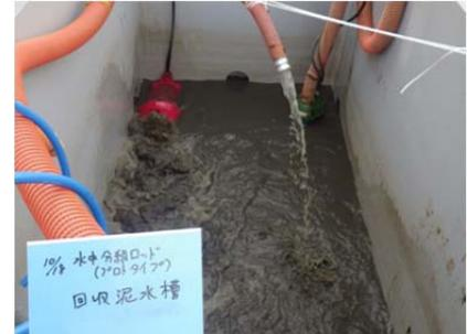
写真-9 泥水として回収した細粒分
