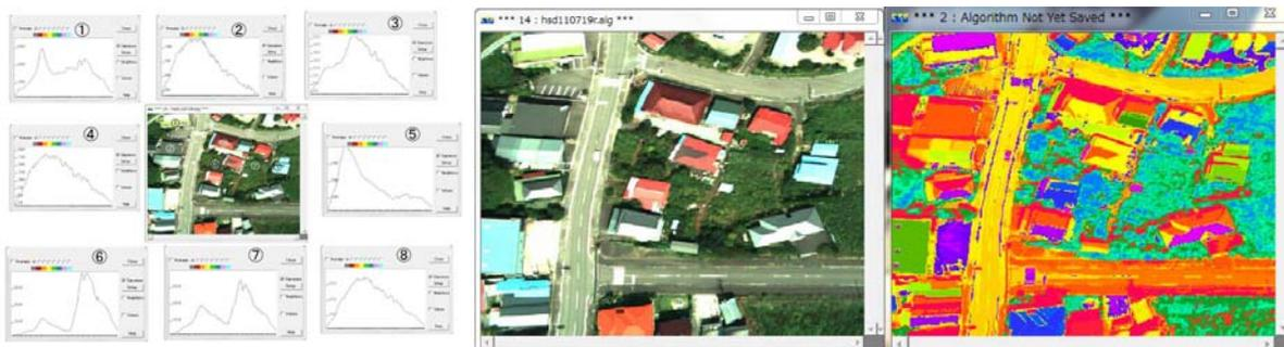
図 4.2 ハイパースペクトル計測による異なる地表面のスペクトル(左)、フォールカラー画像(中)および分類結果(右)
