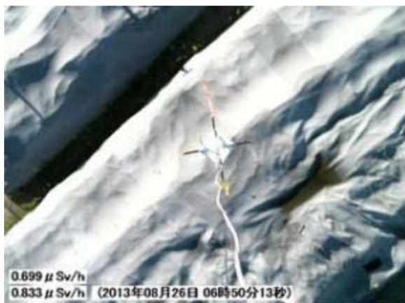
図 3.5 山木屋小学校校庭の残土上に RMAX からシンチレータを接近させている状況
