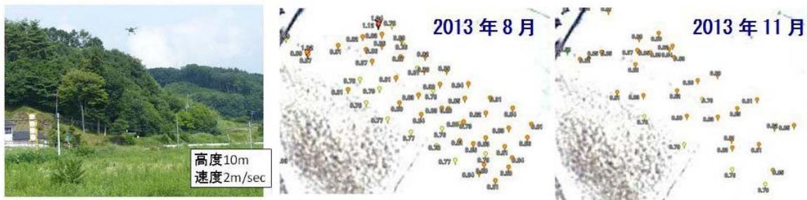
図 3.12 自律飛行（プログラミング飛行）による空間線量率計測の実証実験結果
