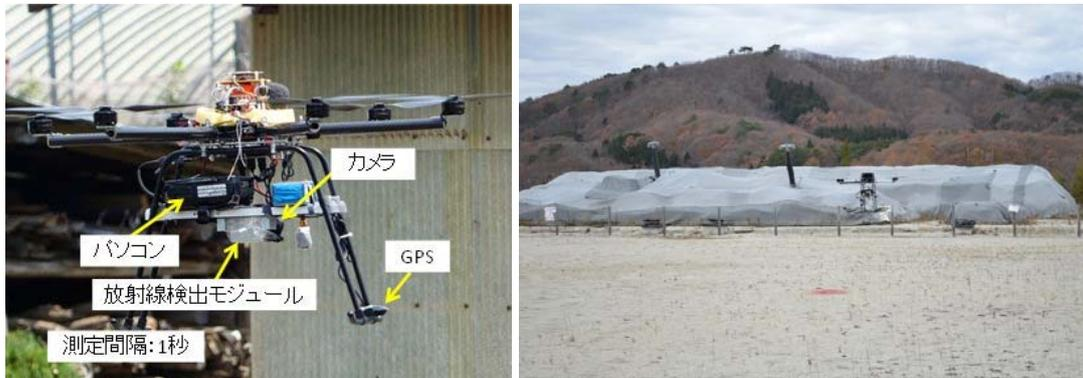
図 3.9 計測器を搭載して飛行中のミニサーバイヤー
