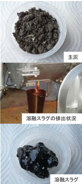
溶融試験における減容挙動と放射性Cs移行挙動 及び焼却灰のしきい値設定
