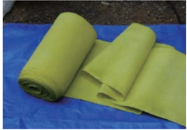
図 6-10-3 セシウム吸着用グラフト除染材料 放射線グラフト重合法によりフェルト状の生地にセシウムを捕捉可能なリンモリブデン酸基を導入した捕集材料の量産化条件を見出すことができました。
