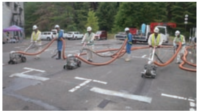
図 4-6-3 1つの超高圧ポンプから3つの洗浄装置で除染できることを確認している試験風景 除染パラメータの最適化で最大3倍までの効率化が図られた。
