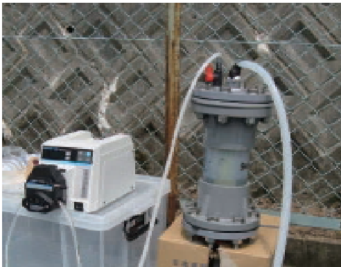
図 6-10-4 セシウム吸着用グラフト除染材料評価装置 学校のプール水からの放射性セシウム除去性能を評価するために、作製した捕集材料を筒状のカラムに充填して評価を行いました。
