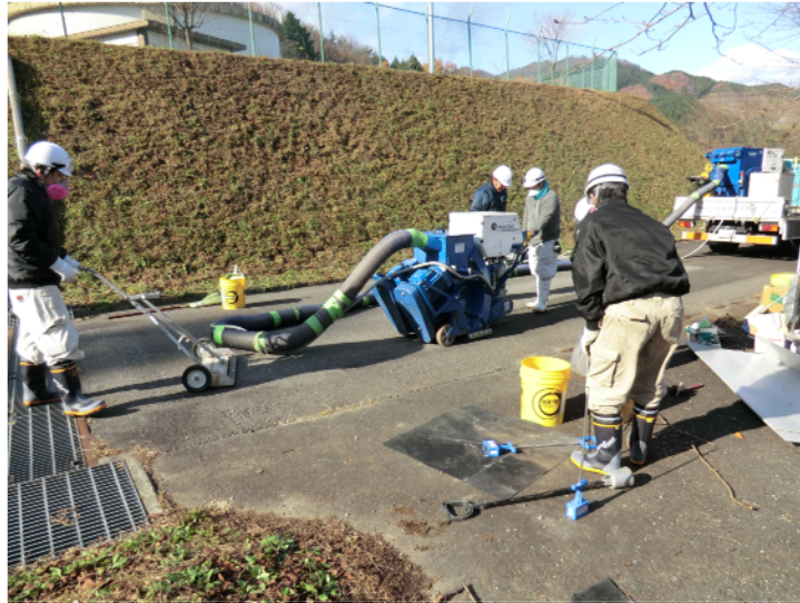
図 3.2.5.1-4 スチールショットブラスト試験の実施状況
