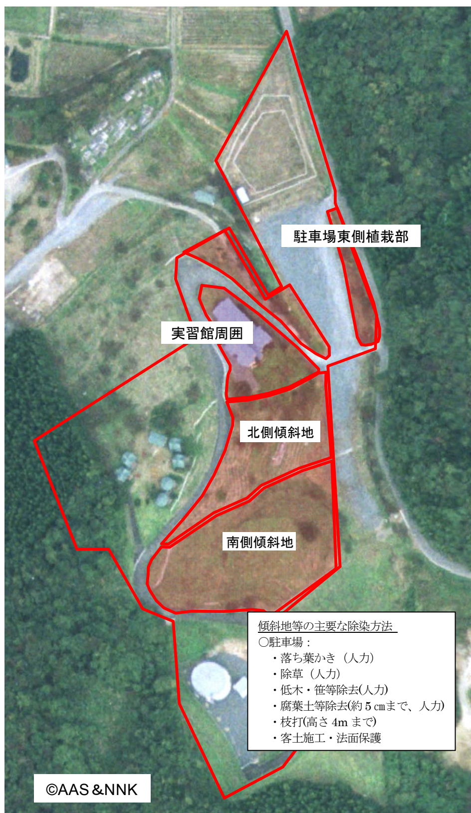
図 3.2.3-5 除染対象毎の除染方法（傾斜地等）
