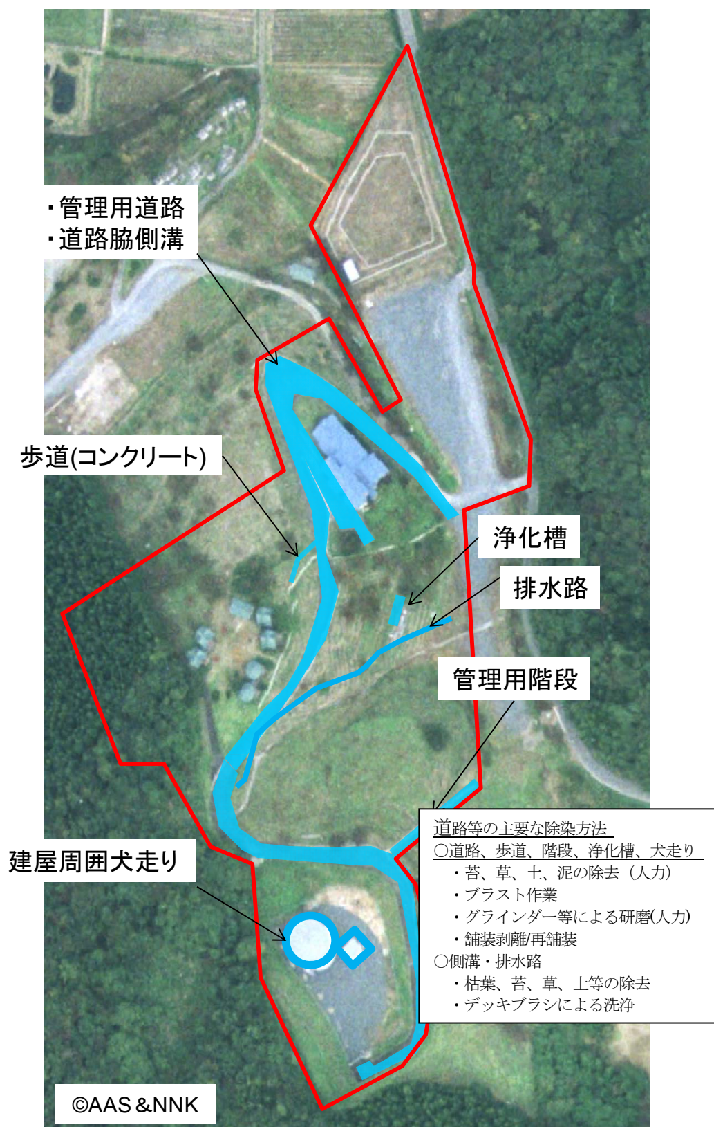
図 3.2.3-7 除染対象毎の除染方法 (道路等)
