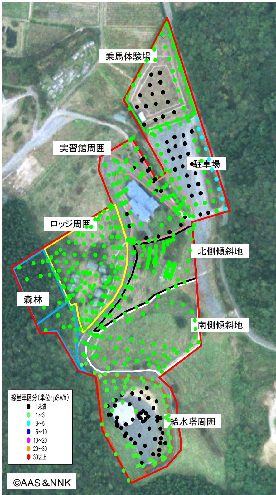
図 3.2.4.6-1 除染区域内の測定結果 (除染後における地表面等から高さ 1m の空間線量率)
