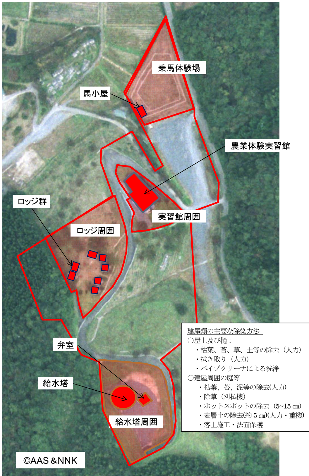
図 3.2.3-3 除染対象毎の除染方法（建屋類及び周辺の庭）
