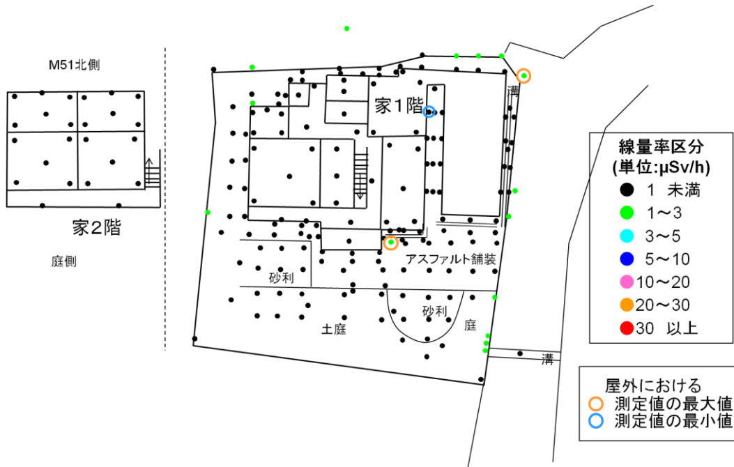
図 3.1.4.6-5 除染後の家屋内外空間線量率の測定結果 (HC 宅, 1m 高さ)
