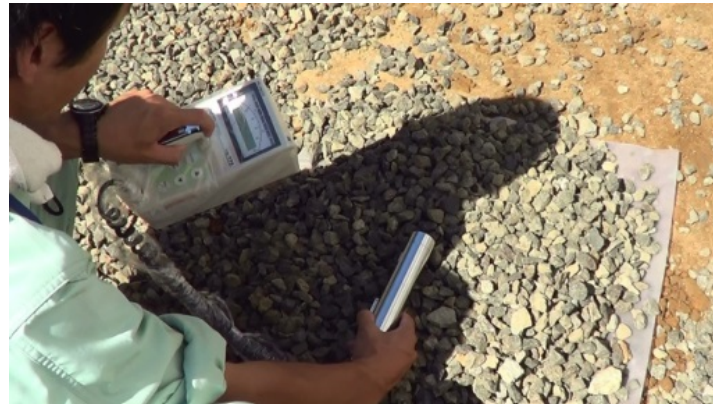
充填容器の一時保管後の空間線量率測定
