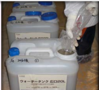
凝集沈殿処理
