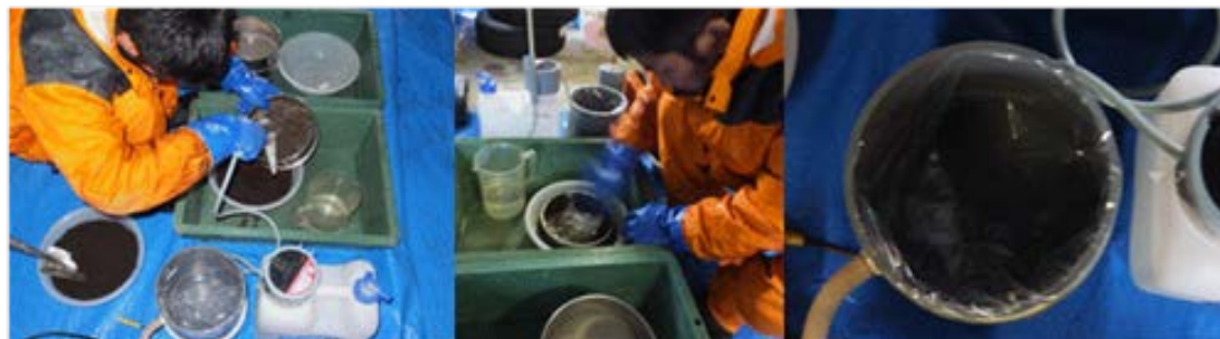
現地での汚染土壌の分級(土壌の粒度を分別)試験
