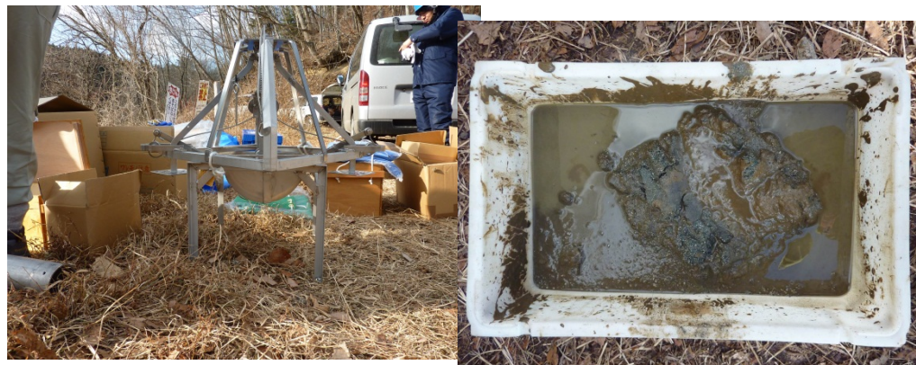
湖底堆積物試料の採取 (スミス・マッキンタイヤ採泥器)
