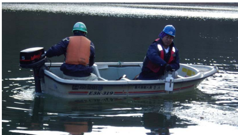
水試料の採取 (ハイロート採水器で表・中・深層で採取)
