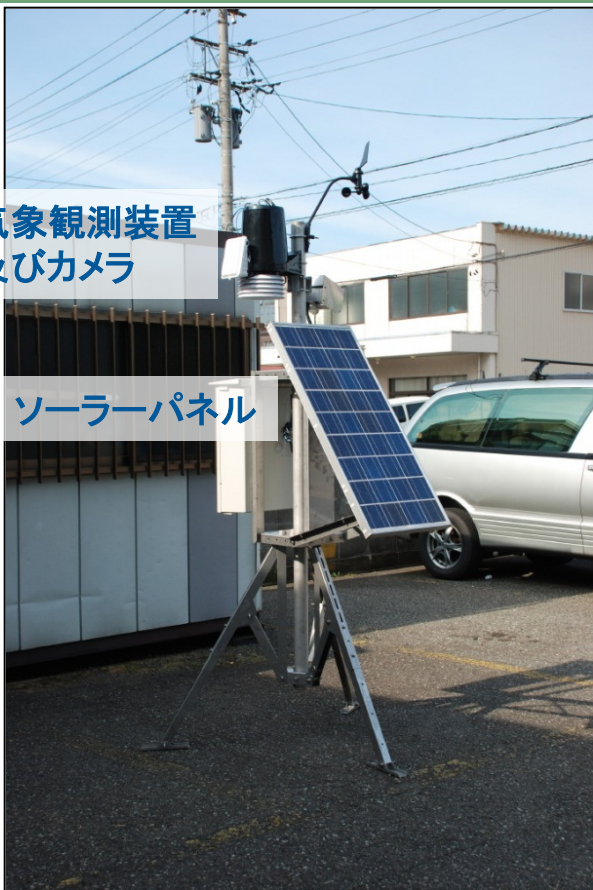
空間線量率計測, GPS, データ記録 及びデータ転送
