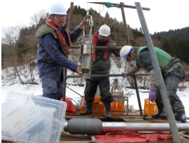
柱状堆積物試料の採取 (不攪乱柱状採泥器)
