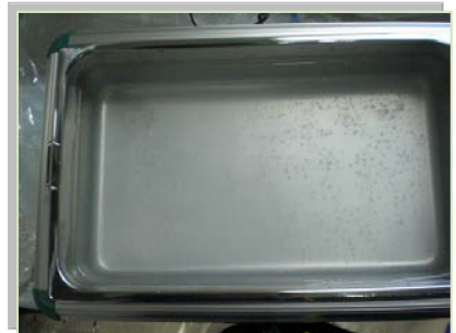
図 6-2-3 試験後の底部状態
