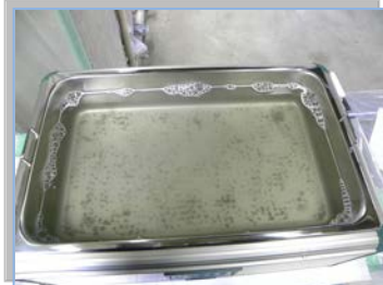
図 6-2-5 試験後の底部状態
