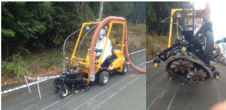
図5-1 除染に影響を与えるパラメータは、水圧、水量と吸引力(右下図)であり、パラメータを最適化することで最大3台同時作業(作業効率3倍)(上図)が可能となりました。また、乗用型の二連ヘッド(左下)も開発しました。
