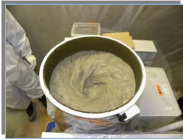
図 6-1-5 摩砕試験状況
