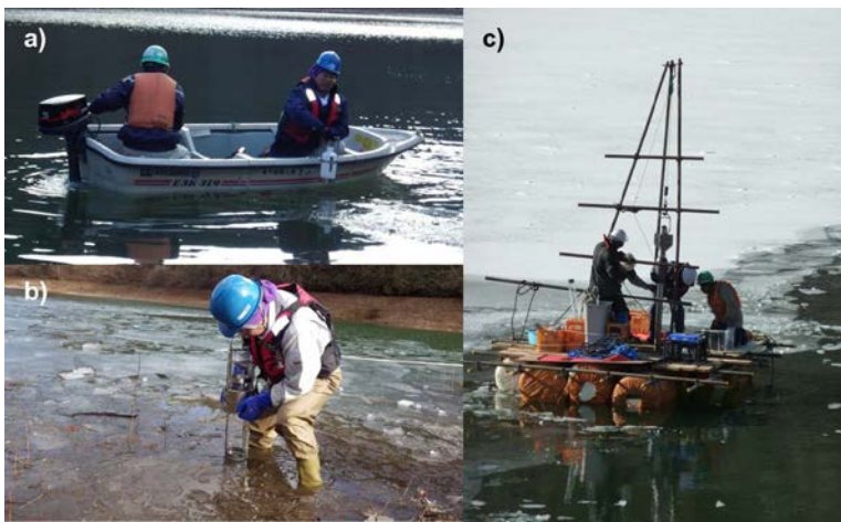
図3-4 ダムにおける試料採取例(川内村荻ダム)
