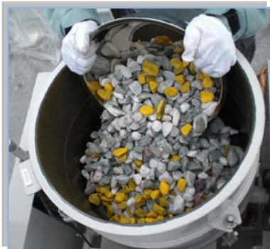
図 6-1-2 模擬試験砂利の投入
