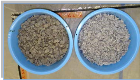
図 6-1-6 試験前(左)と試験後(右)の砂利
