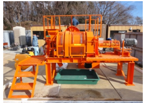
摩砕洗浄機 (洗浄部分：60cm×100cm)
