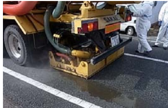
排水性舗装機能回復車による高圧水洗浄
