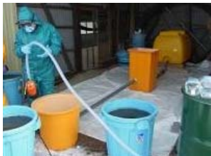
模擬水路による吸着効果確認試験
