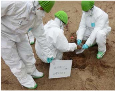
土壤試料の採取作業
