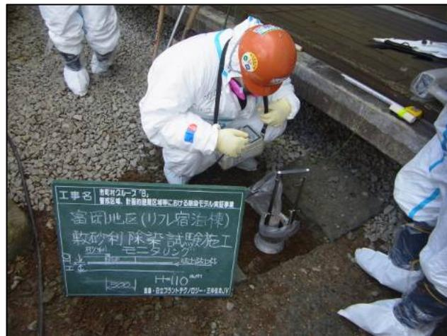
図 3.2-4 コリメータを使用した測定作業の例
