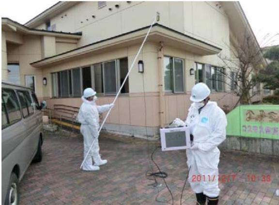
図 3.2-7 エリアモニターによる測定の例
