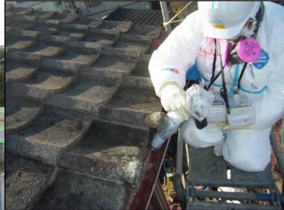
図 3.2-8 サーベイメーターによる測定の例
