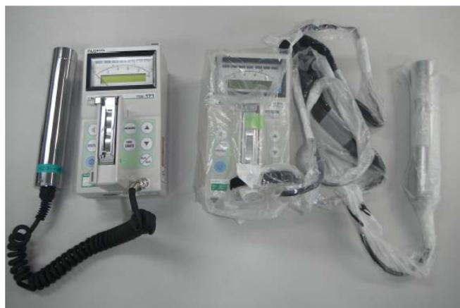
図 3.2-2 線量率計の養生の例（右が養生後）
