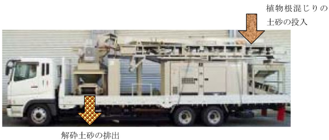
図 2. 4. 2(3)-20 車載型ツイスター
