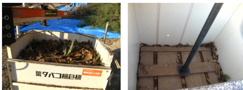
図 2. 4. 2(3)-8 タバコ梱包器による減容化の概要
