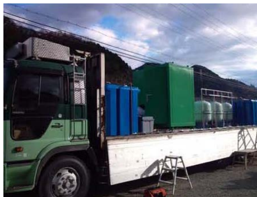
図 2.4.2(2)-9 洗浄水等の車載型水処理装置概要（飯館村）
