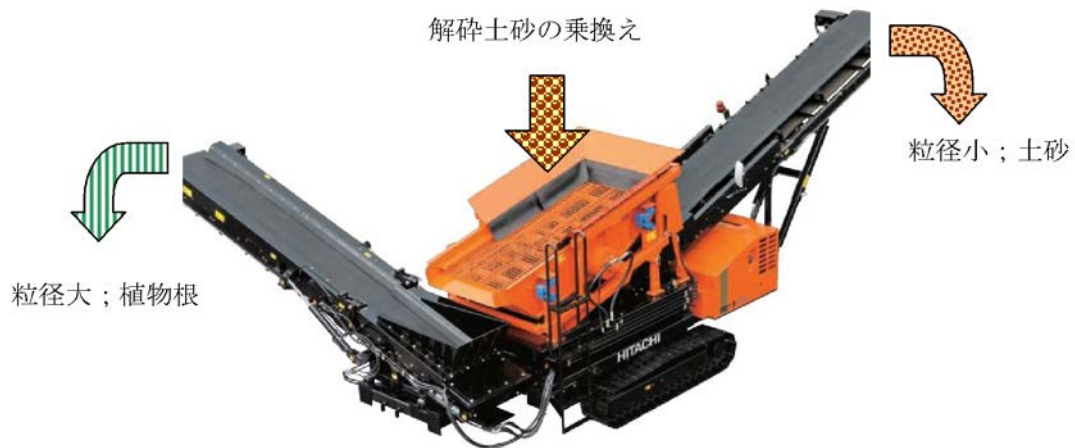
図 2. 4. 2(3)-21 移動式振動フルイ機
