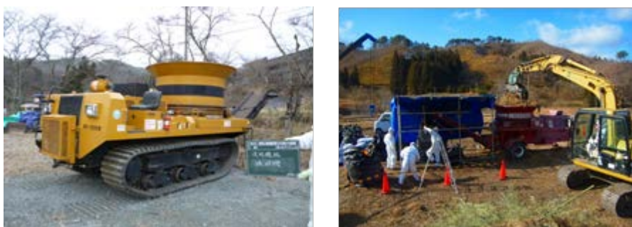
図 2.4.2(3)-1 破砕機による減容化概要
