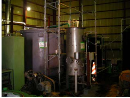
図 2.4.2(3)-14 水熱処理試験装置と試験状況
