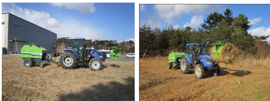
図 2. 4. 2(3)-7 下草集積機（ロールベアラ）による圧縮の概要
