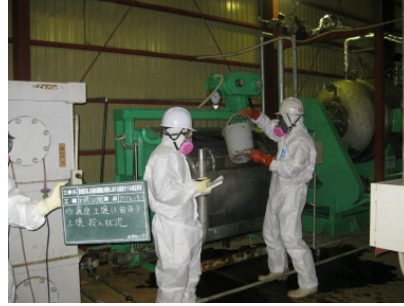
図 2.4.2(3)-14 水熱処理試験装置と試験状況
