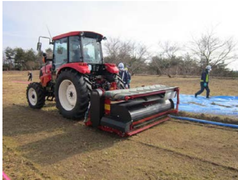
図 2.4.2(1)①(b) II-18 ターフストリッパー実施状況
