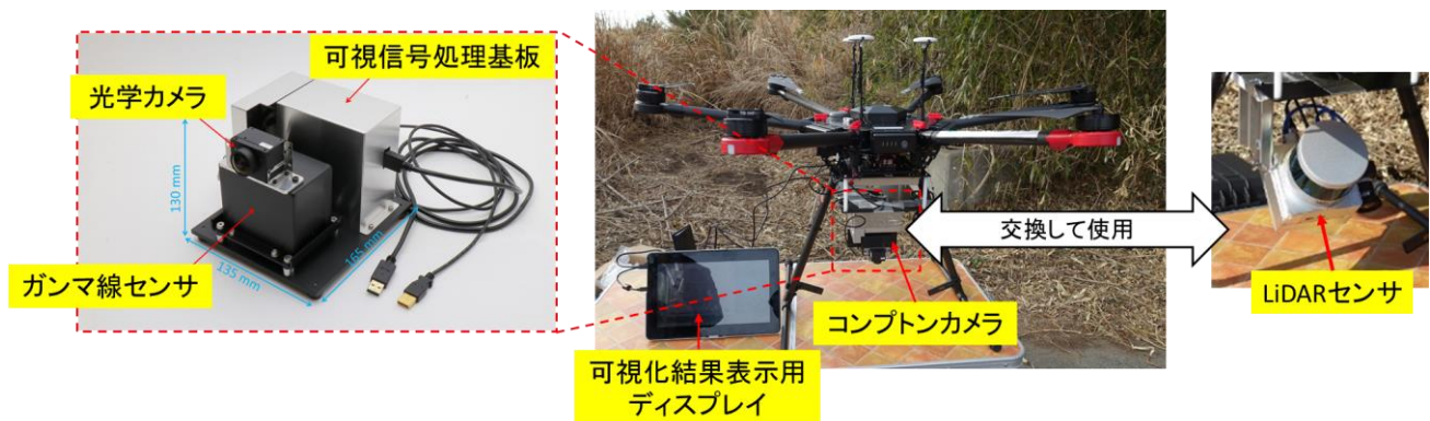
図3 開発した遠隔放射線イメージングシステム。搭載した(左)小型軽量コンプトンカメラと(右)測域センサを示す。
