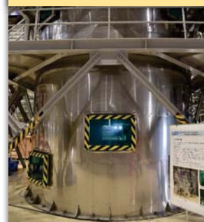
ロボット試験用水槽 (直径 4.5m、水深 5.0m)
