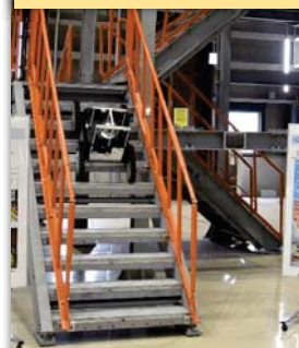
モックアップ階段 (段数11段、階段幅 700~1,000mm) (計測範囲 幅10m×奥行き10m×高さ2m)
