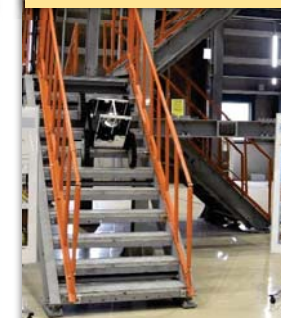
モックアップ階段 (段数11段、階段幅 700~1,000mm) (計測範囲 幅10m×奥行き10m×高さ2m)
