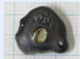
JAEAの茨城拠点で作製した模擬デブリの一例
