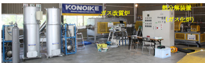
図4 バイオガス化発電により減容化を図る実証試験装置
